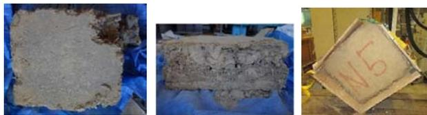
(a) 内壁面(真壁) (b) 断面 (c) 外壁面(大壁)
